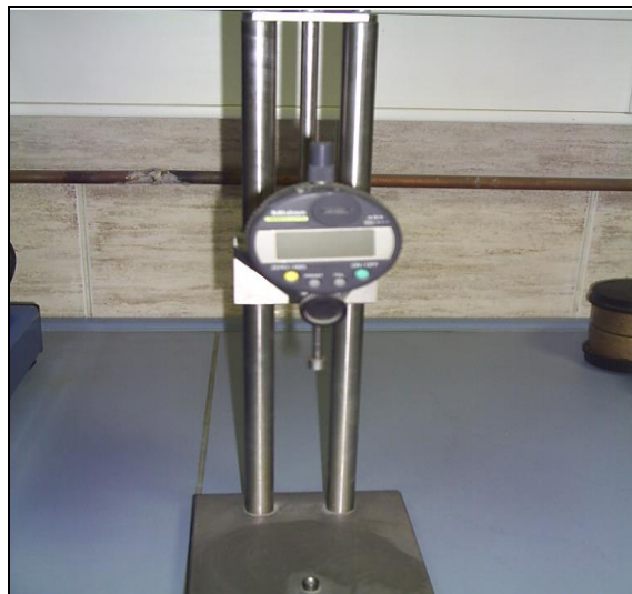
Figure3-18 Comparateur de Retrait (Laboratoire de Lafarge M'sila)
