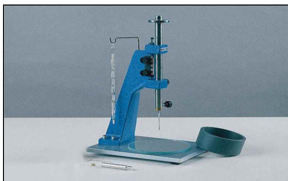
Figure 1-8 Détermination du temps de début de prise.
