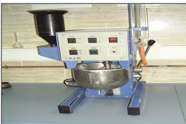
Figure 3-10 Malaxeur semi-automatique de mortier (Laboratoire de Lafarge M'sila)
