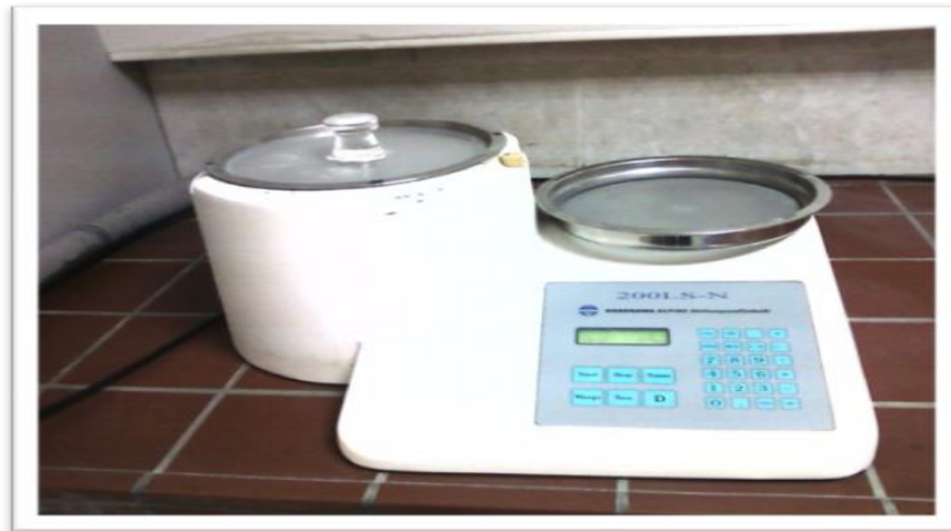
Figure 3-5 Tamiseuse Alpine (Laboratoire de Lafarge M'sila) .
