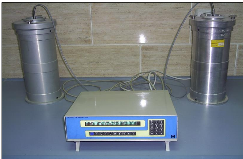
Figure 3-20 Calorimètre Langavant (Laboratoire de Lafarge M'sila).
