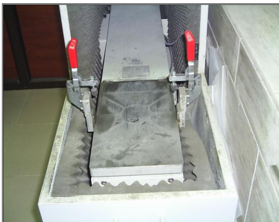
Figure 3-12 Table Vibrante (Laboratoire de Lafarge M'sila)
