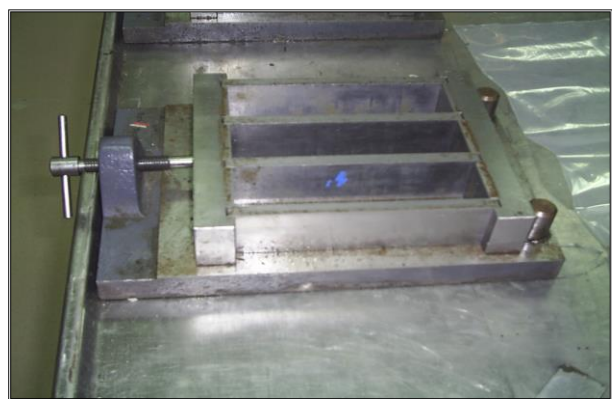
Figure 3-11 Eprouvette Prismatique ( 4x4x16)cm 3 (Laboratoire de Lafarge M'sila)
