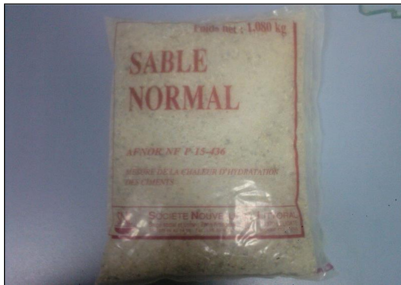
Figure 3-21 Sable Normalisé (Laboratoire de Lafarge M'sila).
